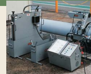
②パイプの融着 (バット)
